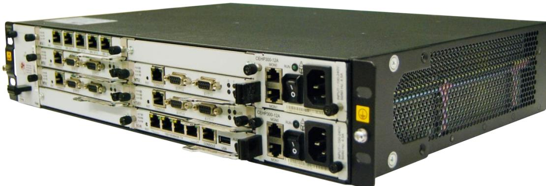
统一网关U1960采用2U标准机箱，定位作为1000用户以内的中小型企业IP语音通信设备，或大企业中型分支机构本地网关接入设备。具备优秀的通信能力，BHCC达36k，MTBF达30000小时，内置语音邮箱，PBX自带Web管理系统，也支持通过专用维护终端LMT和命令行方式维护。
